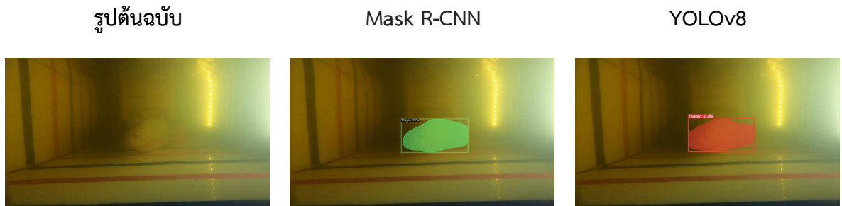
รูปที่ 3.3 เปรียบเทียบการแบ่งกลุ่มปลาในภาพปลาในทิศทางและระยะต่างๆ ด้วยวิธี Mask R-CNN และ YOLOv8 (ต่อ)
